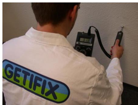
BU: Auch hinter Tapeten oder in Hohlräumen kann Schimmelpilz lauern. Eine Feuchtemessung mittels Kugelkopfsonde gehört deshalb zur Schadensanalyse. (Foto: Getifix GmbH)
